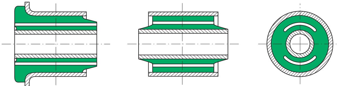
L'articulation alvéolée a pour but d'avoir des rigidités radiales, très différentes suivant les axes de sollicitation perpendiculaires. L'écart de rigidité est réglé par la taille des alvéoles qui peuvent être traversantes ou non.
